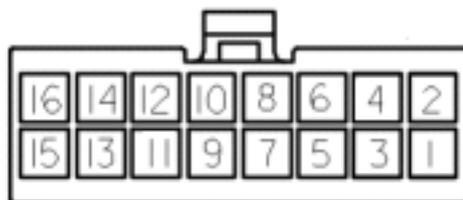
1. Питание +12в. Должно присутствовать на данном контакте в положениях замка зажигания ON и START
